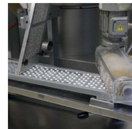
vtlačování tablet do blistrů
