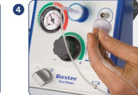
Připojte filtry sprejovací sady k zařízení EASYSRAY. Připojte modře označený filtr k modrému konektoru typu luer s vnitřním závitem a neoznačený filtr ke konektoru typu luer s vnějším závitem.
