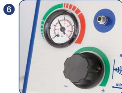
Zkontrolujte tlakoměr na zařízení EASYSRAY, zda ukazuje správný rozsah tlaku 1,5–2,0 bara (21,5–28,5 psi). Upravte nastavení tlaku otočením černého ovladače pro regulaci tlaku.
